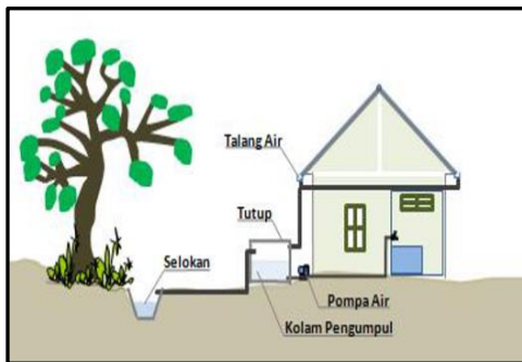
Gambar 2. Sketsa Kolam Permukaan Pengumpul Air Hujan Di Atas Permukaan Tanah
