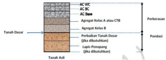
Gambar 2.3, struktur perkerasan lentur pada proyek konstruksi jalan standar Bina Marga di wilayah MBD
