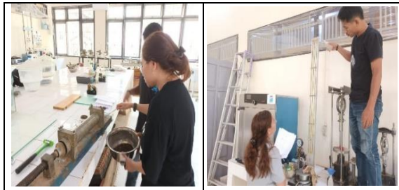
Gambar 4. Proses Uji Permeabilitas Tanah di Laboratorium
