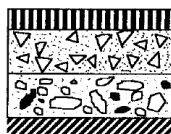
Gambar 2.5. Susunan Lapisan Perkerasan Lentur (Ideal)
