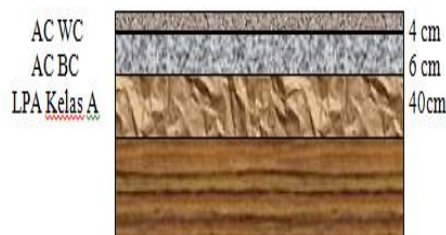
Gambar 3. Susunan Tebal Lapis Perkerasan (Bagan Desain 3B)
